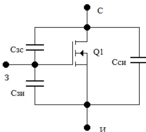
Рис. 3. Паразитные емкости MOSFET транзистора
