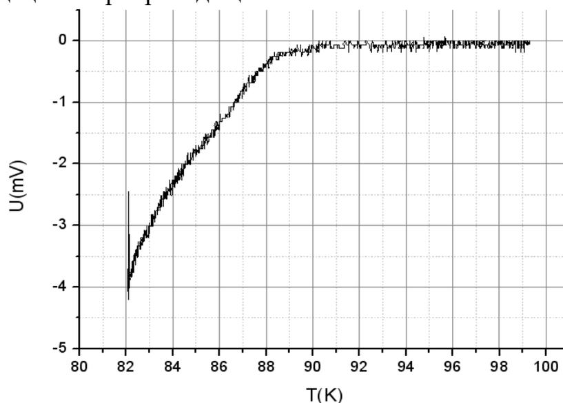
**Рис. 3.** Температурная зависимость напряжения отклика, пропорционального магнитной восприимчивости образца № 1
