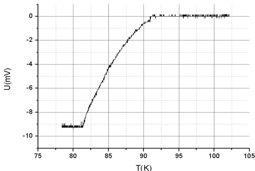
Рис. 4. Температурная зависимость напряжения отклика, пропорционального магнитной восприимчивости образца №2
