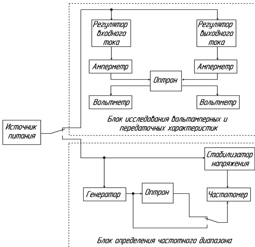
Рис. 2. Структурная схема лабораторного стенда
