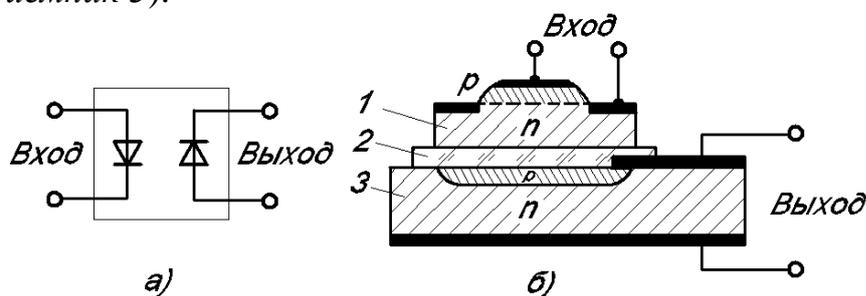
Рис. 1. Схема и технологическое выполнение оптронной пары (оптрона)[3]
