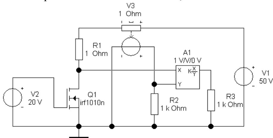
Рис. 1. Схема для моделирования статических характеристик MOSFET ключа
