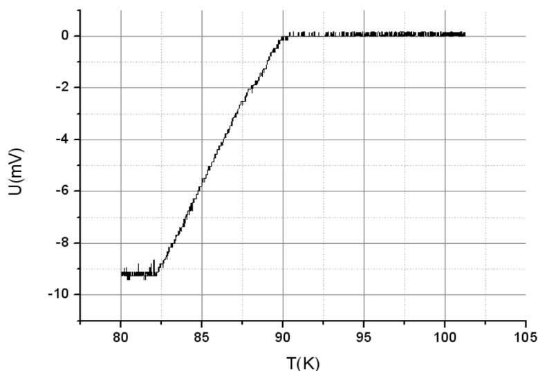
**Рис. 2.** Температурная зависимость напряжения отклика, пропорционального магнитной восприимчивости контрольного образца №0  $\text{YBa}_2\text{Cu}_3\text{O}_7$
