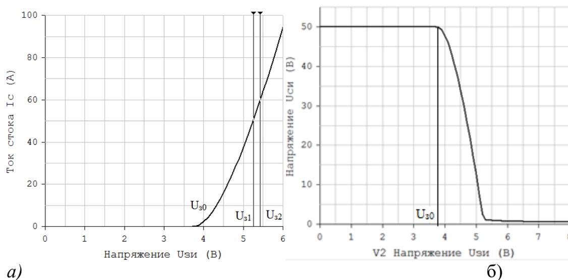
Рис. 2. Характеристики ключа: а) стоке-затворная (проходная); б) передаточная
