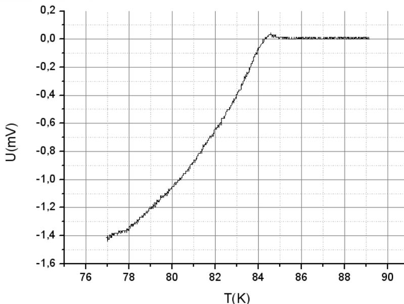
**Рис. 6.** Температурная зависимость напряжения отклика, пропорционального магнитной восприимчивости образца №2 после повторного спекания
