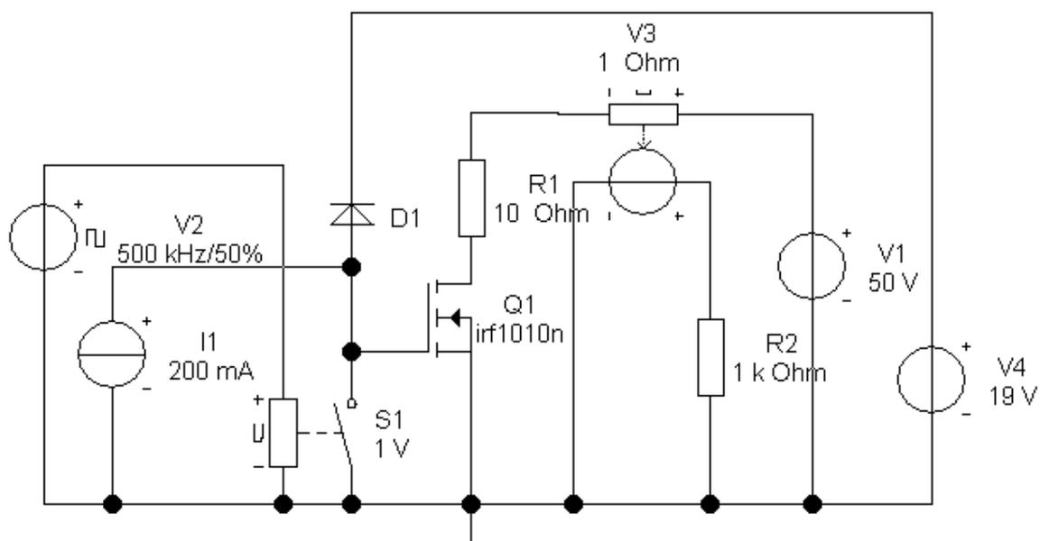
Рис. 4. Схема для исследования динамики MOSFET ключа
