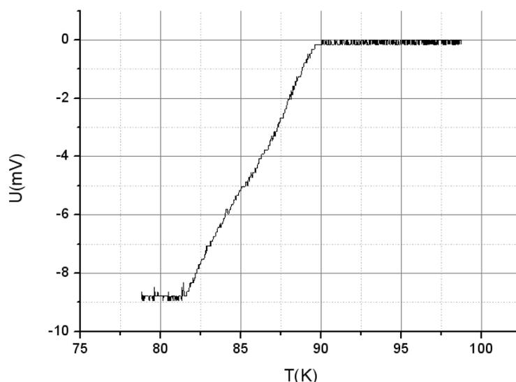
Рис. 5. Температурная зависимость напряжения отклика, пропорционального магнитной восприимчивости образца № 3
