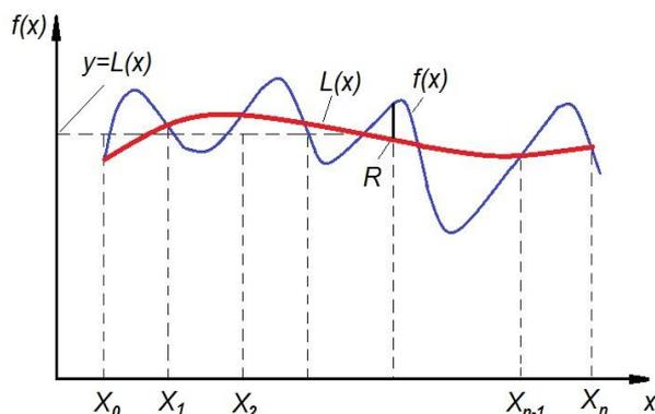
Рис. 1. Иллюстрация интерполяции функции
