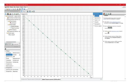
Рис. 4. График зависимости напряженности от расстояния
