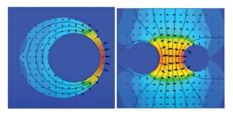
**Рис. 1.** Модель электростатического поля двух цилиндров в системе ELCUT
