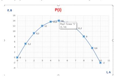
Рис. 1. График зависимости мощности аккумулятора от величины постоянного тока
