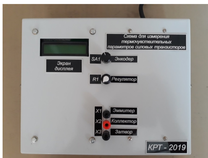
Рис. 3. Внешний вид устройства для измерения мощности потерь и термочувствительных параметров силовых транзисторов
