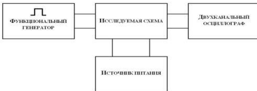
Рисунок 1. – Структурная схема исследования электронного ключа.
