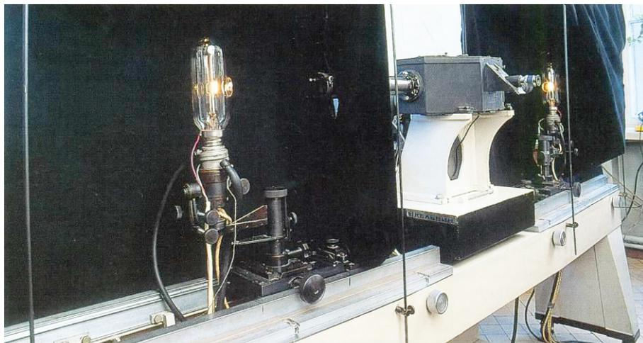
**Рис. 2.** Спектрокомпаратор из состава фотометрической аппаратуры для построения температурной шкалы оптическим методом в составе Государственного первичного эталона единицы температуры – Кельвина
