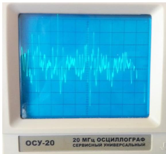
**Рис. 3.** Осциллограмма колебаний, генерируемых плазмой на экране осциллографа
